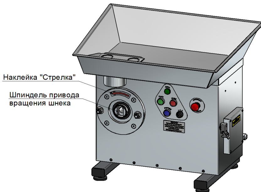
Рис. 3 Контроль направления вращения привода шнека
